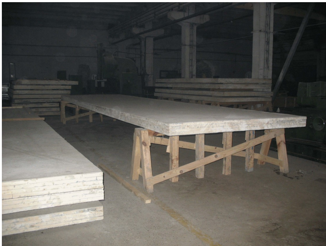
Fig.16. Panouri pentru acoperis (h = 145 mm ; l = 2,5 m ; L = 10 m)
