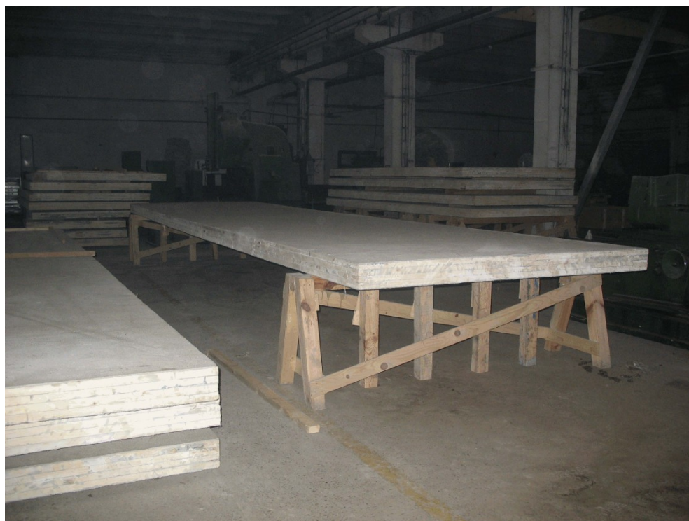
Fig. 8. Panou pentru acoperis ( h = 145 \text{ mm} ; l = 2,5 \text{ m} ; L = 10 \text{ m} )
