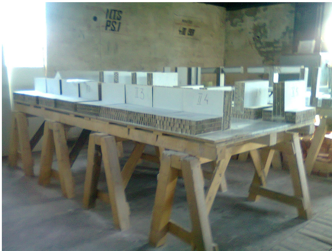
Fig.18. Sisteme de imbinare la 90° a panourilor (epruvete)
