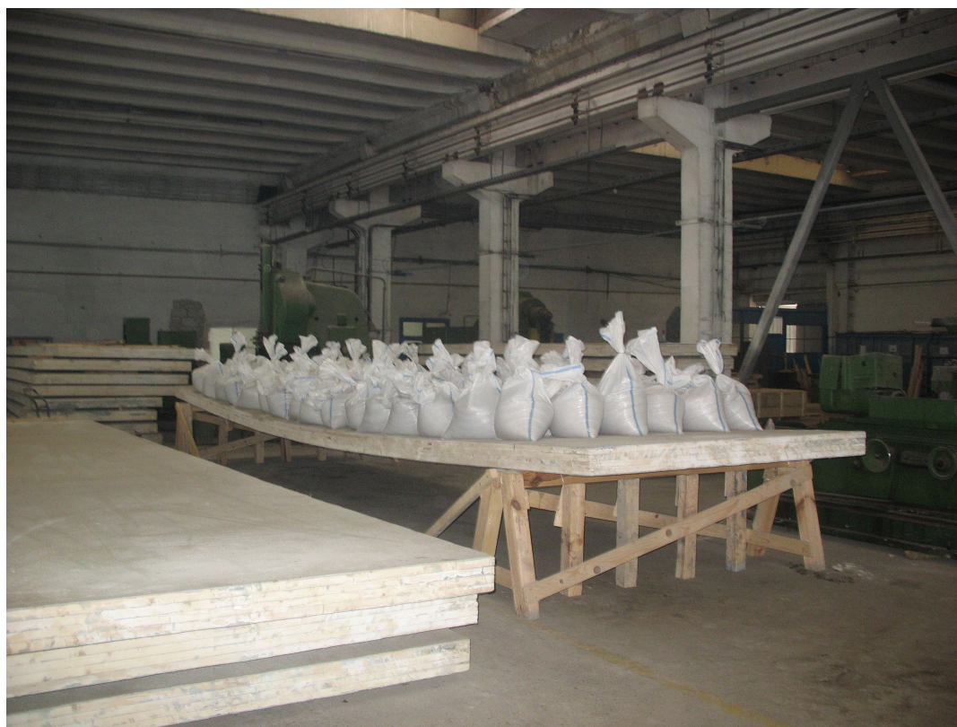
Fig.21. Testarea panoului de acoperis. Masa = 7800 Kg
