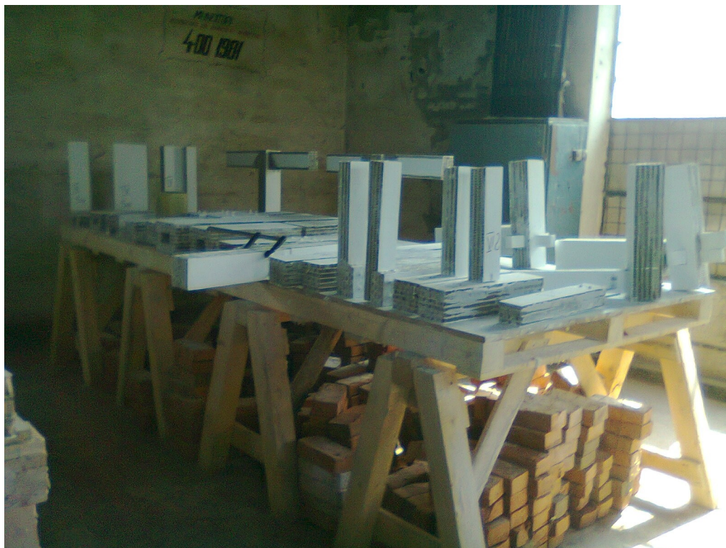
Fig.20. Sisteme de imbinare stalp - grinda (epruvete)
