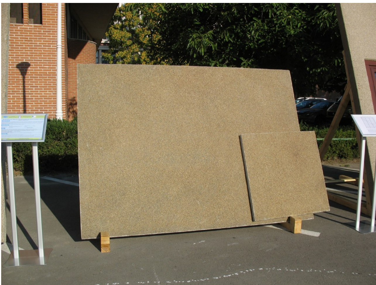
Fig. 6. Panou pentru termoizolare (h=50 mm, l=1,5 m, L= 3 m)
